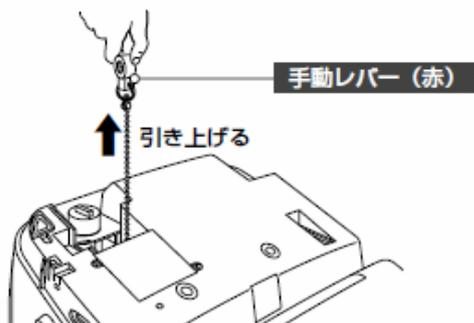
❹ 手動レバー（赤）を元の位置に戻し、時計回りに約 180° 回し、通水を止めます。
